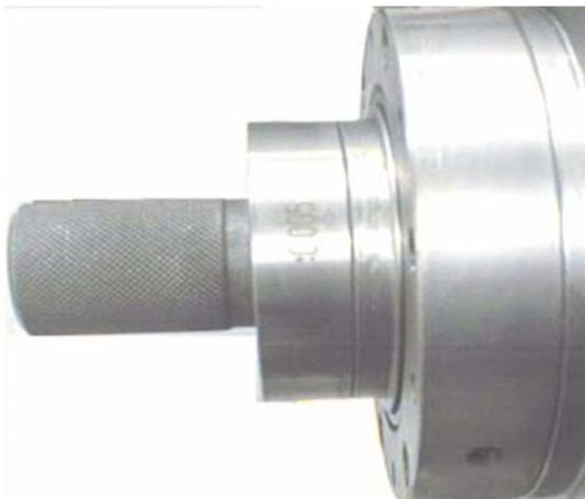
Abbildung 30: Positionierung der Passscheibe zwischen den Oberflächen des Kaliberanschlages und der Spindelwelle
