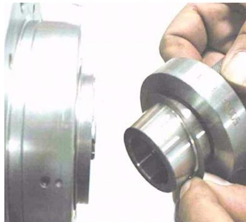
Durch die Verwendung der Kaliber kann das Spannfutter HSK sofort auf die Quote gebracht werden, nach der die Sensoren eingestellt werden; dadurch erfolgt die Eichung nicht nur schneller, sondern auch genauer, denn die Kaliber wurden mit engeren Toleranzen als die herkömmlichen Werkzeughalter ausgeführt.
