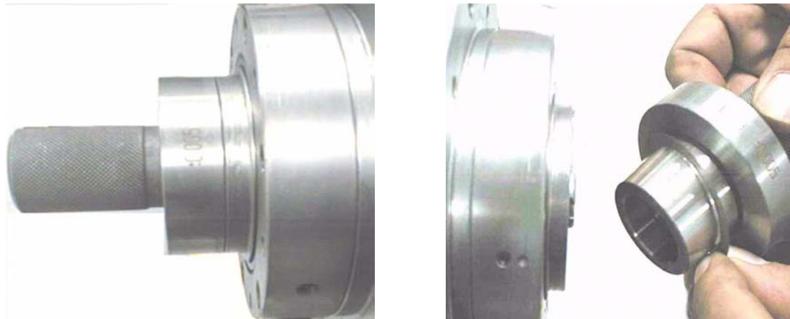
Figure 29: utilisation du calibre comme un porte-outil normal, avec ou sans cale interposée
