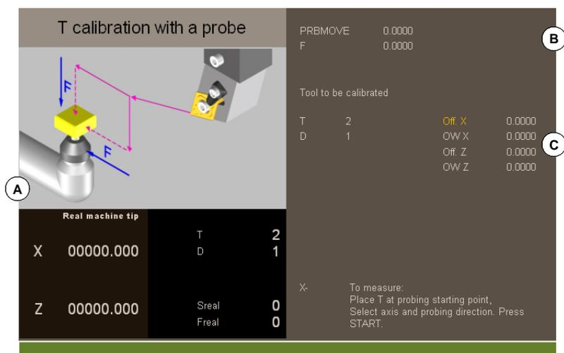
**A** Données de la machine. Position des axes, outil et correcteur actif, vitesse réelle de la broche et avance réelle des axes.
