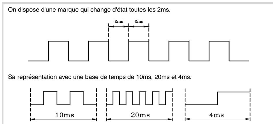
La fenêtre graphique étant sélectionnée, les touches "+" et "-" permettent de diviser ou de multiplier par deux la base de temps.
