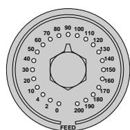
Le déplacement se réalise à l'avance définie par le fabricant de la machine. L'avance pourra varier entre 0% et 200% avec le sélecteur d'avances du panneau de commande.
