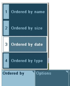
Le menu de touches logiciel se déroule et s'enroule avec les touches [F1] à [F7]. Les touches logiciel du menu déroulant se sélectionnent avec la touche [ENTER] ou depuis le clavier numérique, en utilisant le numéro accompagnant chacune des touches logiciel.
