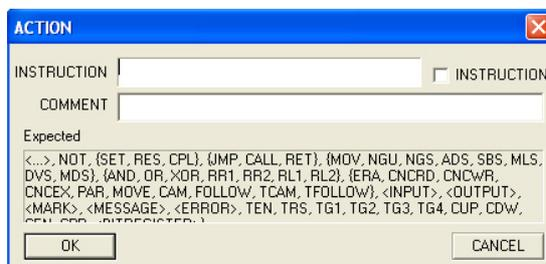
L'instruction doit être écrite en langage de mnémoniques. En situant le curseur sur contact\_action, avec la touche logiciel "Parallèle" on peut ajouter d'autres contacts\_action en parallèle.
