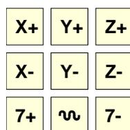
Le clavier dispose de deux touches pour chaque axe. Une touche pour déplacer l'axe dans le sens positif et une autre pour déplacer l'axe dans le sens négatif.
