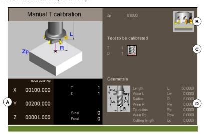
• Tool calibration window (·T· model).
