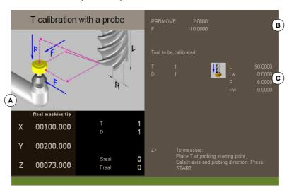
• Tool calibration window (·T· model).
