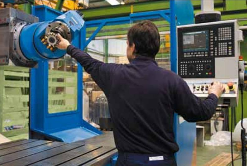
Während der Bearbeitung eines Werkstücks gestattet die CNC eine Unterbrechung der Programmausführung zur Prüfung des Istzustands des Werkstücks und zur Ergreifung der entsprechenden Gegenmaßnahmen.
