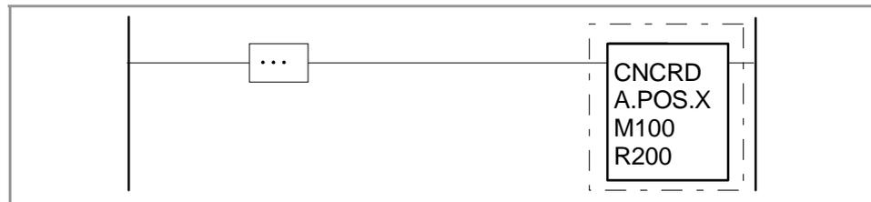
Indem der Cursor auf das Element Kontakt\_Abfrage bewegt wird und die Taste [ENTER] gedrückt wird, erscheint ein Dialogbildschirm, um einen Befehl und einen Kommentar zu verbinden. Im Feld "Se espera" bietet man eine Kontexthilfe mit den gültigen Anweisungen an.
