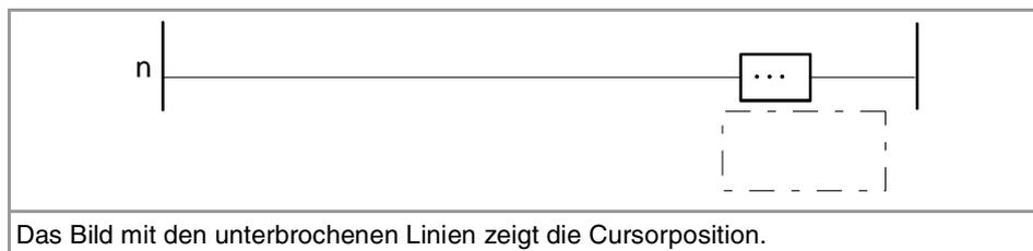
Indem der Cursor auf das Element Kontakt\_Aktion bewegt wird und die Taste [ENTER] gedrückt wird, erscheint ein Dialogbildschirm, um einen Befehl und einen Kommentar zu verbinden. Im Feld "Se espera" bietet man eine Kontexthilfe mit den gültigen Anweisungen an.
