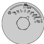
Auswähler für den manuellen Bewegungstyp; jog fortlaufend, jog ansteigend oder fliegend. Im Steuerradbetrieb ermöglicht er die Anwahl der Vervielfältigungsfaktors der Impulszahl des Steuerrads (x1, x10 oder x100). In inkrementaler Betriebsart ermöglicht er die Anwahl des inkrementalen Werts der Achsverstellung.
