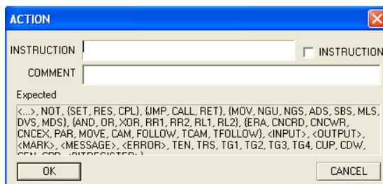
Den Befehl muss man in der Sprache der Mnemonik schreiben. Der Cursor wird mit Hilfe der Schaltfläche "Parallel" zum Element Kontakt\_Aktion bewegt und Sie können andere Elemente vom Typ Kontakte\_Aktion parallel hinzufügen.
