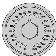
Das Verfahren erfolgt mit der Vorschubgeschwindigkeit, die vom Hersteller der Maschine festgelegt wurde. Der Vorschub kann zwischen 0 % und 200 % variieren; dieser wird mit dem Wahlschalter für Vorschub auf Bedienpult eingestellt.
