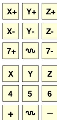
Die Tastatur verfügt über zwei Tasten für jede Achse. Einer zum Verfahren der Achse in positiver Richtung und einer zum Verfahren in negativer Richtung.
