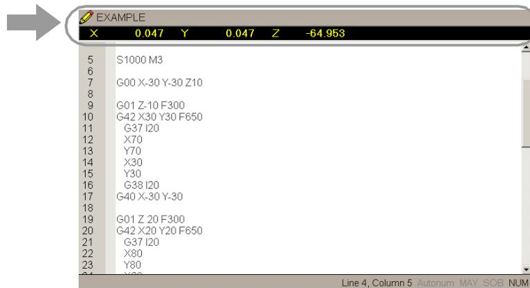
Bei aktiver Betriebsart TEACH-IN können die Koordinaten der Achsen durch direkte Edition von der Tastatur aus verfolgt werden oder ihnen kann die Position zugeordnet werden, die die Maschinenachsen einnehmen. Beide Editionsweisen können unterschiedslos und selbst während der Definition eines gleichen Satzes benutzt werden. Zur Definition der Koordinaten einer Achse oder mehrerer Achsen durch TEACH-IN:
