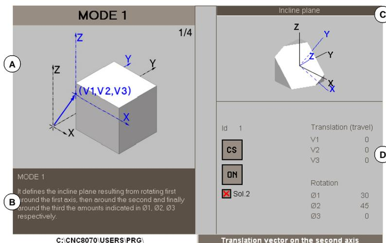
**A** Hilfefgrafik. Folge von Abbildungen, die bei jedem einzelnen der Schritte gezeigt wird, um die geneigte Ebene zu definieren. Sobald ein programmierbarer Parameter markiert ist, stoppt die Parameterfolge und die Zeichnung mit der entsprechenden Erklärung wird angezeigt.
