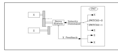
MACHINE PARAMETERS Axis parameters
