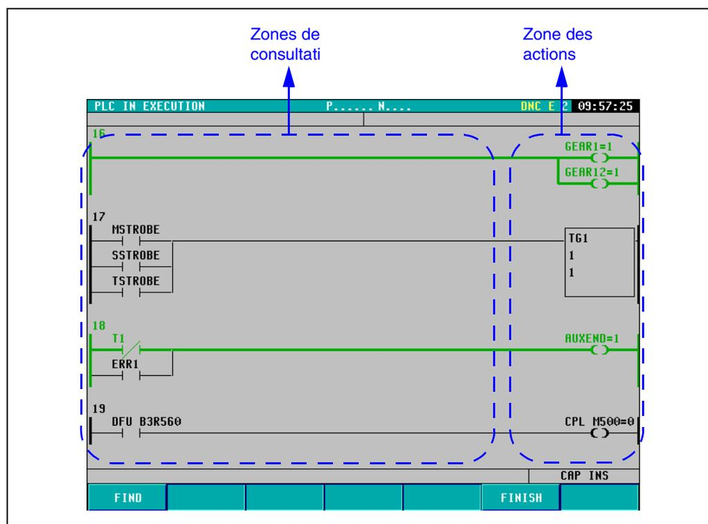
Comme on peut le voir sur la figure, les instructions du programme de PLC en langage de contacts sont composées d'éléments connectés entre eux par des segments. De plus, le chemin logique parcourant le flux est souligné d'une ligne verte plus épaisse et les valeurs de registres, temporisateurs, contacteurs, etc. sont affichées.
