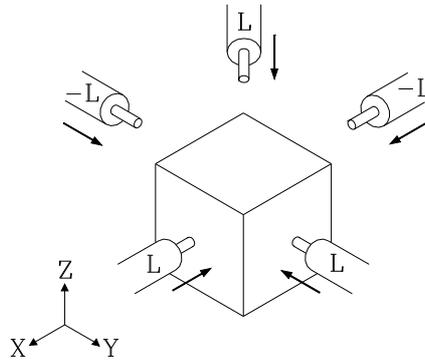
En réalisant une simulation du programme pièce, la CNC analyse la valeur affectée à la longueur de l'outil "L" dans le correcteur correspondant.
