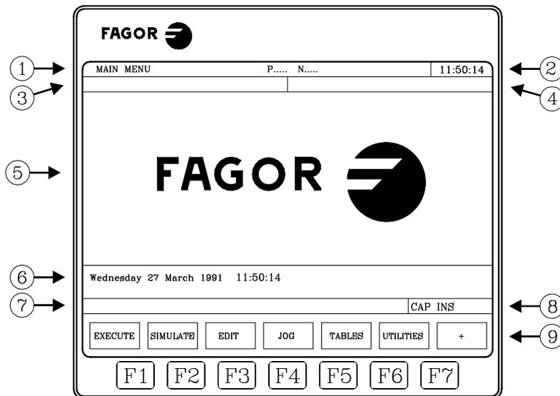
1. Dans cette fenêtre est indiqué le mode de travail sélectionné ainsi que le numéro de programme et le numéro de bloc actif. l'état du programme est aussi indiqué (en exécution ou interrompu) et si le DNC est actif.
