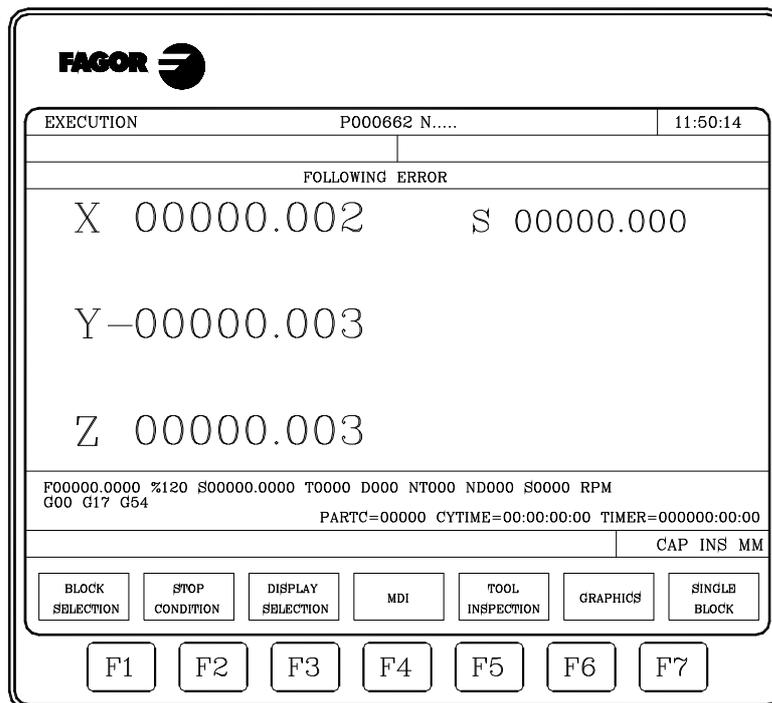
Le format d'affichage de chaque axe est indiqué par le paramètre machine d'axes "DFORMAT".
